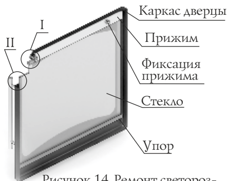
Рисунок 14. Ремонт светорозрачного экрана дверцы печи «Витрувия»
