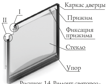
Рисунок 14. Ремонт светопрозрачного экрана дверцы модели «Витра»
