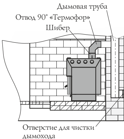
Рисунок 13. Схема присоединения котла к стационарному дымоходу
